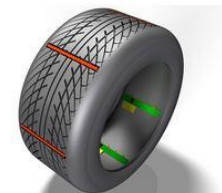
Modellskizze des S-Tyre Prototypen mit einfachem Sensorarray - © pd2m 2014
